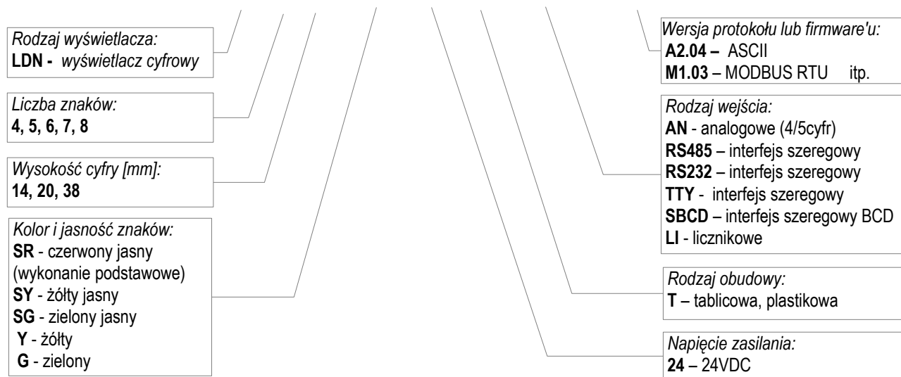
Rys. 1. Sposób oznaczenia wyświetlaczy tablicowych LDN-...-T-...
