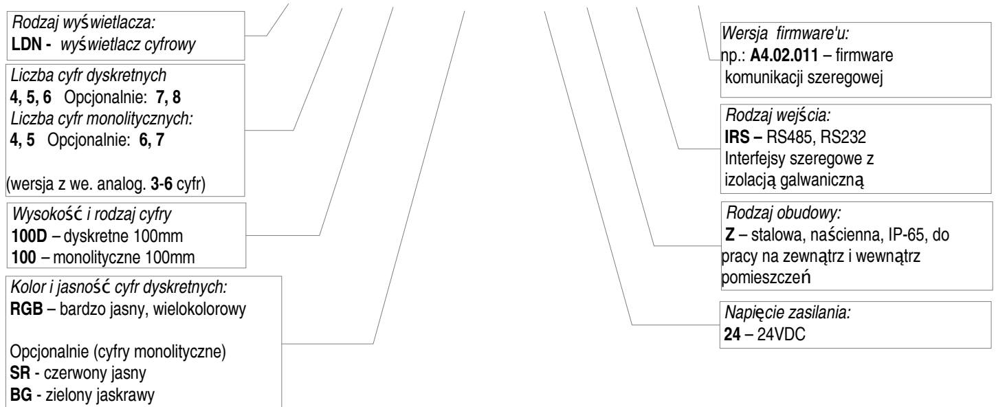
Rys.1.5.1. Sposób oznaczenia wyświetlaczy naściennych LDN-x/100D-...-Z-IRS
