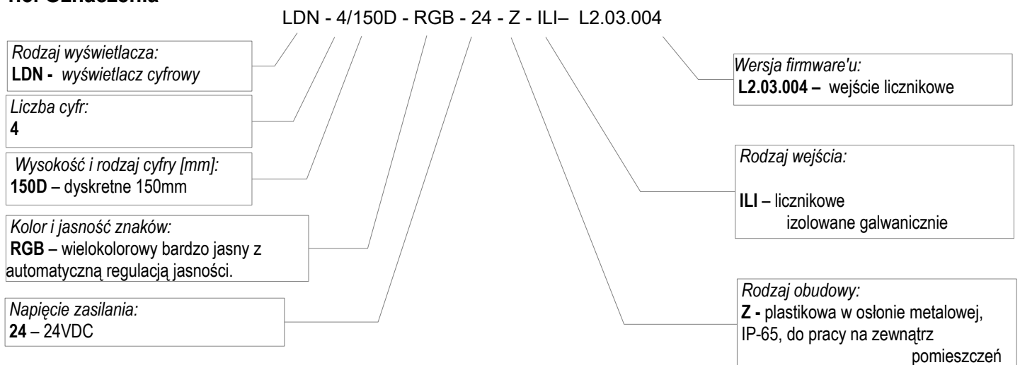
Rys.1.5.1. Sposób oznaczenia typu wyświetlacza
