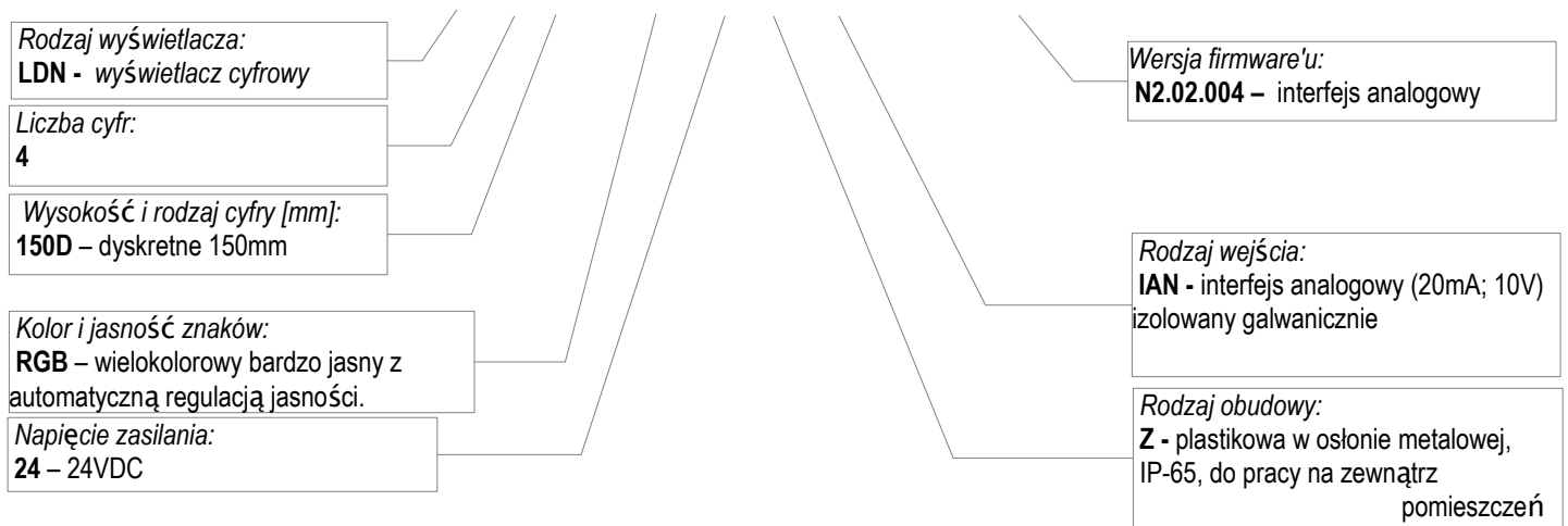
Rys.1.5.1. Sposób oznaczenia typu wyświetlacza
