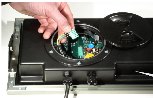
Rys. 3 Widok listwy połączeniowej, po zdjęciu pokrywy. Widok i położenie klawiatury.
