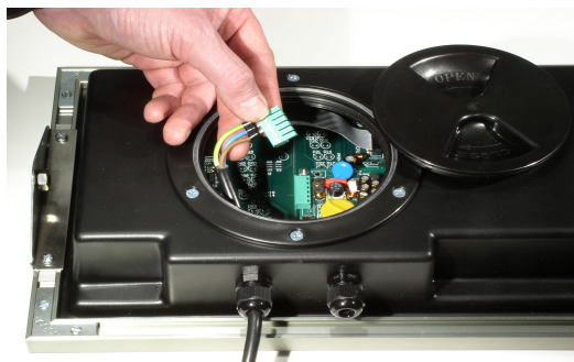
Rys. 2 Widok listwy połączeniowej, po zdjęciu pokrywy.
