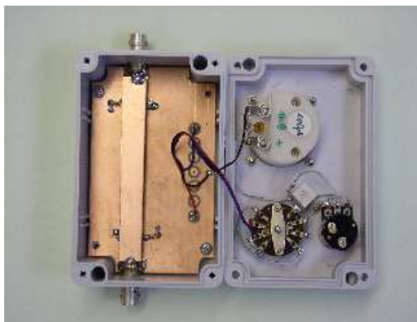
Widok wewnętrzny. Linia paskowa przykryta ekranem.
