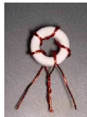
Transformator T1 Ph 4A11
